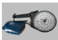
Lo spessore della fodera imbevuta è oltre 1,45 mm garantendo tenuta ed impermeabilità mantenendo una notevole destrezza. Garantisce performance di resistenza all'abrasione + 13% in riferimento al Valore massimo (4) della Norma EN 388:2016 .
